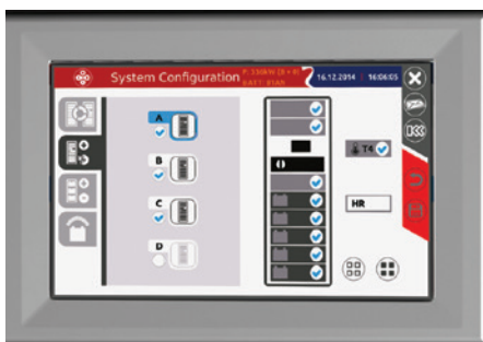
Pantalla táctil LCD del MPW: configuración y monitorización SAI orientada al cliente.
